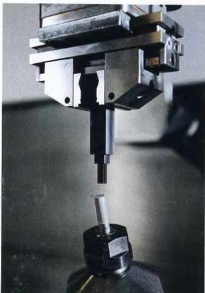
Bild 6: In ein Probewerkstück aus Magnesium werden zur Erforschung mittels einer Senkelektrode 0,4 bis 0,8 mm große Kanäle eingebracht
