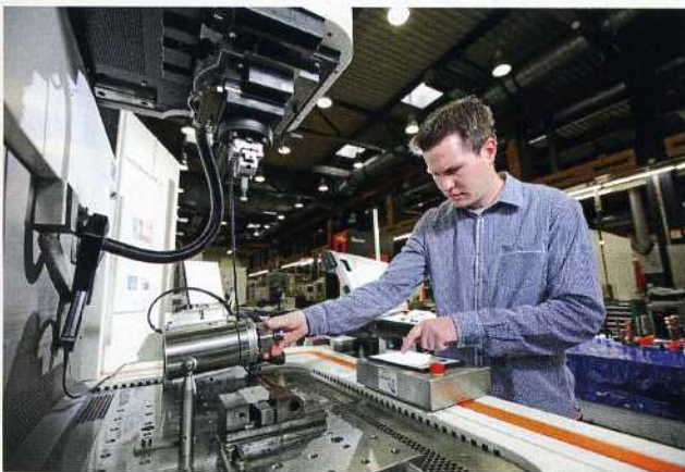
Bild 8: Für die Abteilung Abtragende Fertigungsverfahren erforscht Max Schwade an einer FORM 2000 von GF Machining Solutions Senkerodierverfahren mit dem Werkstoff Magnesium
