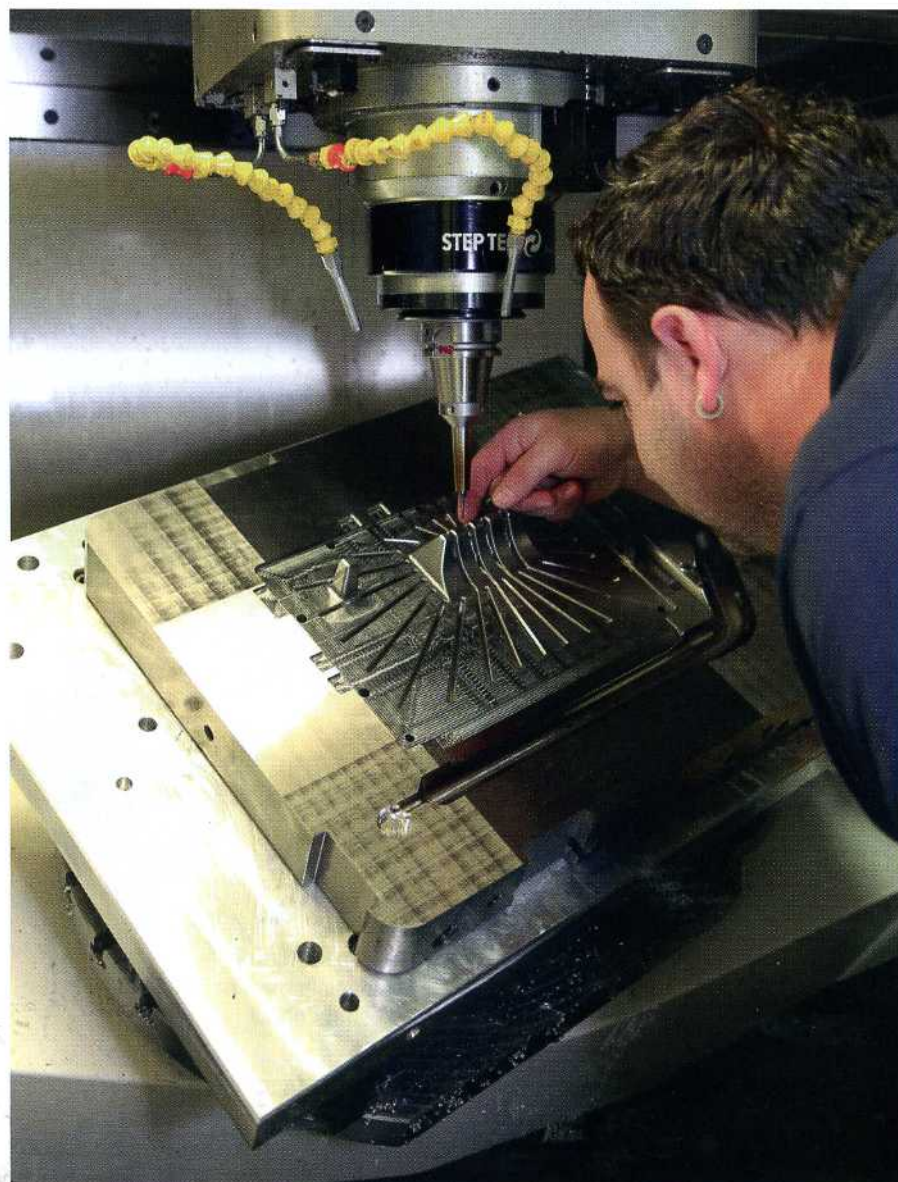
Blick in das 5-Achs-Simultan-BAZ «Mikron HPM 600U», dessen Stärke eine hohe Zerspanleistung ist, aber nicht nur.
