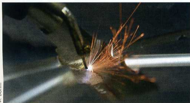
Spezielles Oberflächenverfahren zur Vermeidung von Kaltflussstellen im Druckguss: Die Angüsse werden per Hand mit Wolfram beschichtet.
