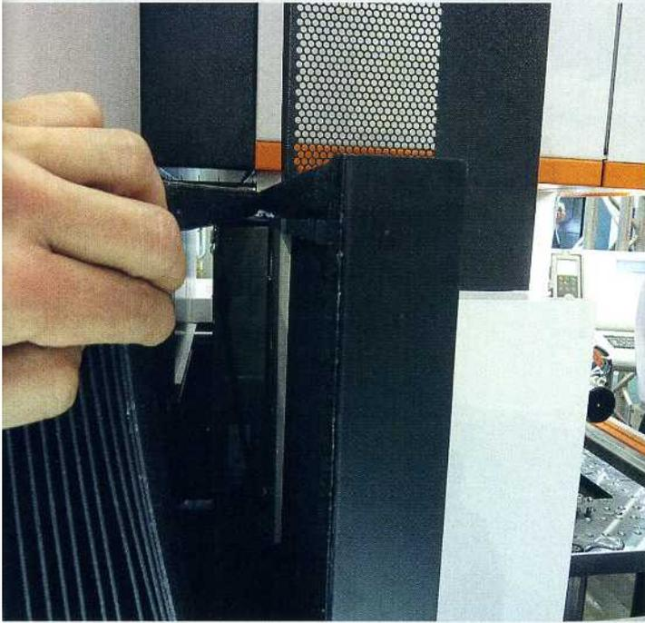
Gut verkleidet hinter der Z-Achsenabdeckung: der Cut-2000-S-Generator. Die minimierte Strecke vom Generator zum Draht verlangt nur ein sehr kurzes Kabel, was vor allem den Wechselstromwiderstand entscheidend reduziert.
