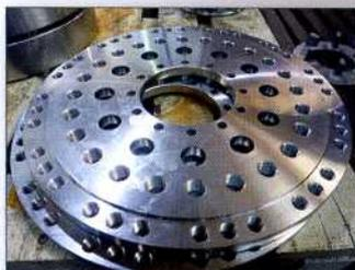
Ein typisches Beispiel für ein Werkstück, das sowohl hohe Zerspangungsleistung als auch hochpräzise Passungs-Bearbeitung erfordert: Ideal für die MMV-1500 F
