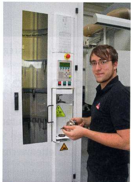
Alles am rechten Ort: Bis zu 115 Werkzeuge sind im Werkzeugturm untergebracht. Matthias Eckl ist für die Mikron HPM 800 U – und damit für die wertvollste und technisch umfangreichste Anlage im Maschinenpark – verantwortlich.
