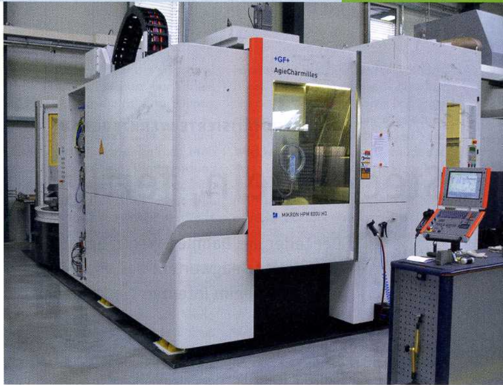
Viel Funktion auf wenig Raum: 5-Achs-Fräsbearbeitungszentrum Mikron HPM 800 U inklusive 7-fach-Palettenwechsler und Werkzeugturm.
