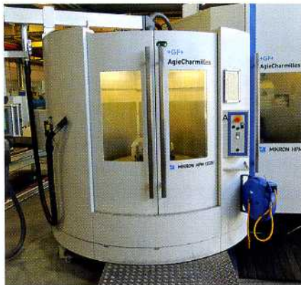
Bei der Herstellung der kleineren Bauteile sorgen zwei Mikron HPM 1350U mit Werkzeug- und Palettenwechsler für mehr Produktivität.
