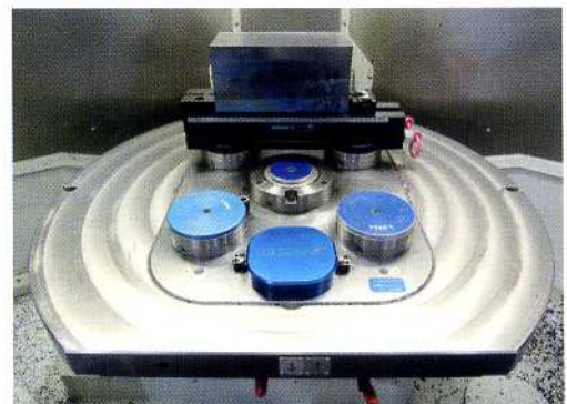
Nullpunktspannsysteme ziehen sich durch alle Fertigungsstationen bei BMW Werkzeug- und Anlagenbau.
