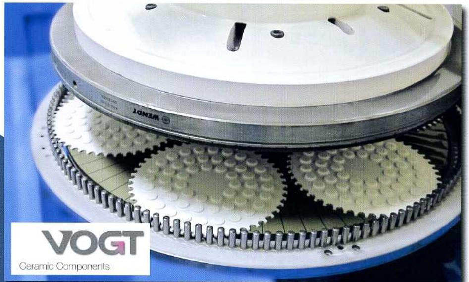
Doppelseiten-Planschleifen von Keramikwerkstücken mit Diamantscheiben für höchste Präzision im Mikrometerbereich
