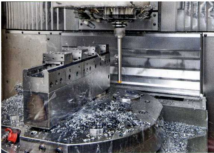
Der AMF-Cleaner reinigt im Eilgang und lässt sich einfach in den Automationsablauf einbinden
