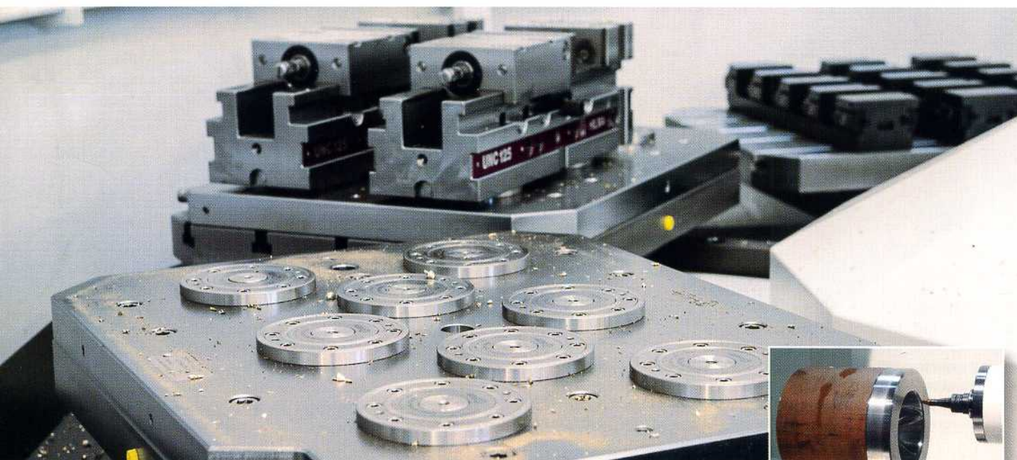
Oben: Wechselpaletten bestückt mit Nullpunktspannsystemen ermöglichen mannlose Geisterschichten. Bild: AMF. Rechts: Die Nullpunktspannung trägt entscheidend zur Rüstkostensenkung bei. Bild: Lang
