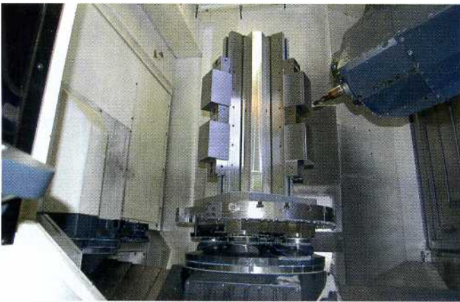
Der gesamte Aufspannturm sitzt mitsamt Grundplatte auf Paletten-Spannköpfen von Röhm mit sehr grossen Einzugskräften.
