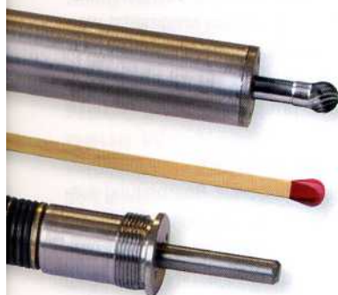
Bild 2. Mit Mikro-Spannsystemen, die kleiner als ein Streichholz sind, werden beispielsweise in der Zahn-technik Implantate bearbeitet
