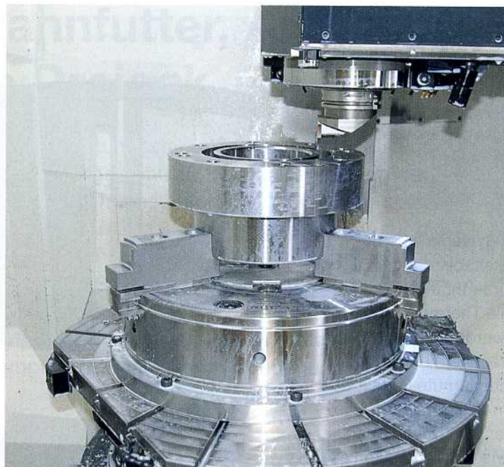
Bild 6: Die Rund- und Planlaufgenauigkeit des DURO-T ist doppelt so gut wie nach DIN-Genauigkeitsklasse 1 vorgeschrieben
