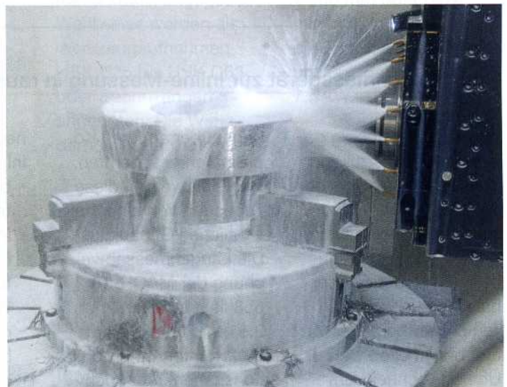
Bild 8: Die neu entwickelte Spritzwasserkante des Röhm-Futters lenkt das Medium optimal
