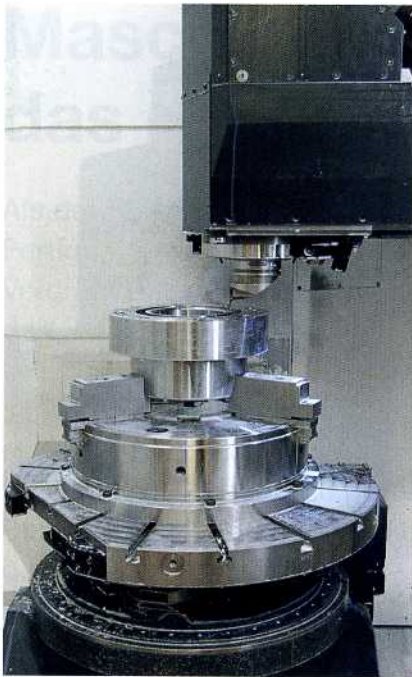
Bild 5: Röhm hat beim neuen Zentrisch-Spannfutter DURO-T die Spannkräfte gegenüber dem Vorgängermodell noch einmal um 20 % erhöht
