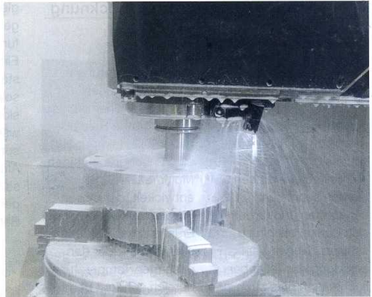
Bild 7: Die Kombination aus DMC Bearbeitungszentrum, DURO-T Spannfutter und Präzisionsanforderung bei Maag Pump Systems hat alle zu Höchstleistungen gebracht
