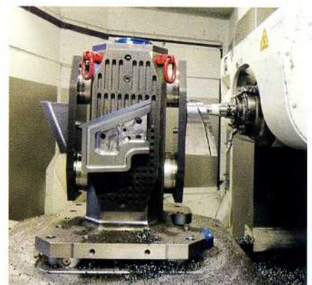
GF Machining Solutions hat die beiden Mikron HPM 1350U angepasst auf die bei BMW übliche Trockenfräsbearbeitung.
