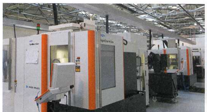
Um effizienter zu werden, legte sich der Rennstall Lotus sechs identische Fräszentren mit integrierter Automation zu.
