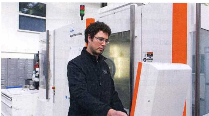
Mit den 5-Achsen-Fräszentren des Typs Mikron HPM 450 U bearbeitet das britische Formel-1-Team Lotus Werkstücke in nur einer Aufspannung. (Bilder: Lotus/GF Machining Solutions)
