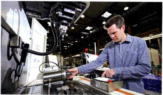
Für die Medizintechnik: Max Schwade erforscht an einer »Form 2000« Senkerodierverfahren mit dem Werkstoff Magnesium. Bild: GF Agie
