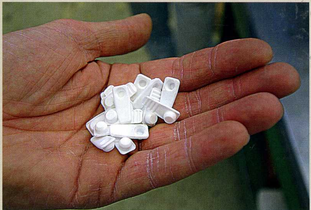
Immer wieder waren diese Kunststoffflaschen doppelt eingespritzt worden. Mit Umstellung auf die Gasdruckfedern von FIBRO kommt das nicht mehr vor.
