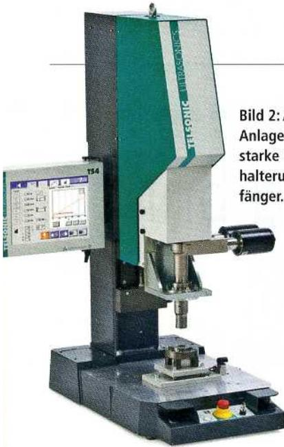
**Bild 2:** Auf einer vollautomatischen Anlage schweißen 1,2 bis 2,4 kW starke Ultraschallköpfe die Sensorhalterungen in die lackierten Stoßfänger.
