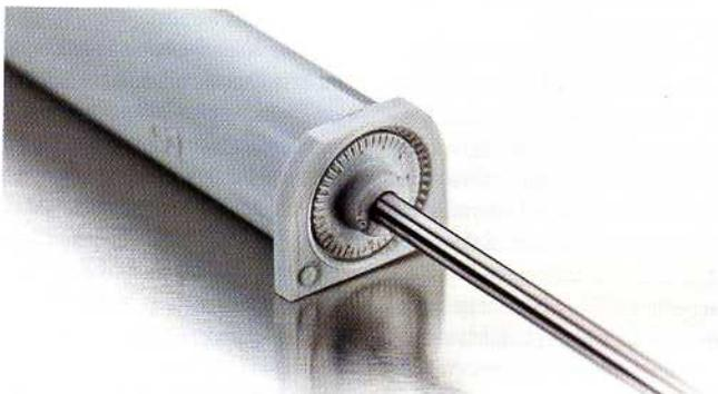
**Die Möbelstoßdämpfer werden mit dem Soniqtwist-Verfahren vollautomatisch am Boden und am Deckel öl- und gasdicht verschweißt** Foto: Telsonic
