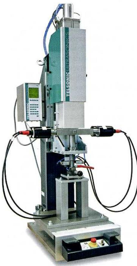
Telsonic hat das torsionale Ultraschallschweißen zu einem prozesssicheren Verfahren mit wiederholgenauen Ergebnissen entwickelt
