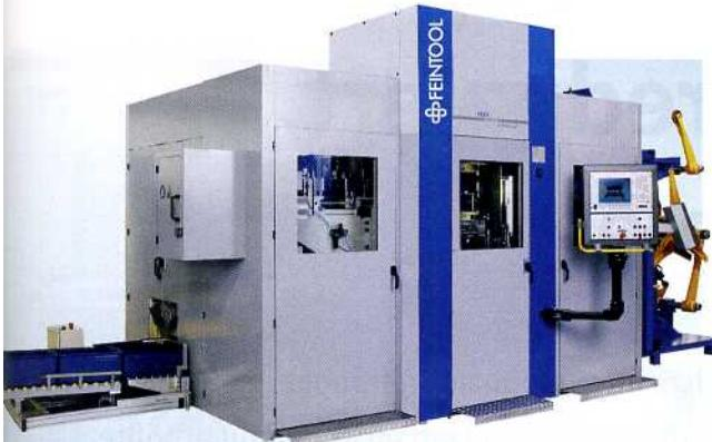
Eine Feinschneidpresse des Typs Feinspeed X-TRA 320 von Feintool ersetzt beim Lohnfertigungsunternehmen Fritz Schiess zwei ältere Maschinen.
