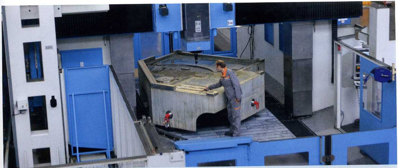
24 Maßarbeit Aus optimiertem Spezialbeton von Durcrete gefertigt und von Spezialisten bei Daetwyler in der Schweiz hochpräzise bearbeitet, taugt das Maschinenbett für einen genauen und robusten Zahnrad-Prüfstand.
