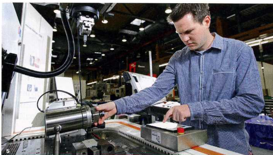
4 Ein einziges Drahtführungssystem der Cut 2000 ermöglicht die Benutzung von verschiedenen Drahtdurchmessern. 5 Für die Abteilung Abtragende Fertigungsverfahren erforscht Max Schwade an einer Form 2000 von GF Machining Solutions Senkerodierverfahren mit dem Werkstoff Magnesium.
