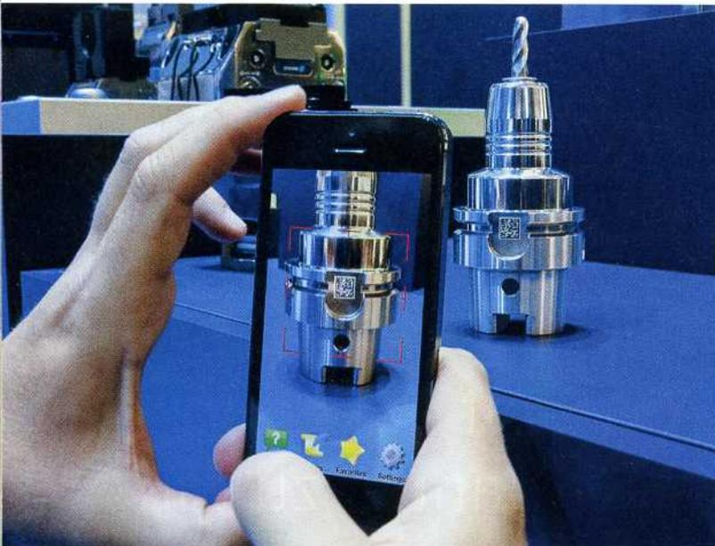
Werkzeughalterkennzeichnung für die Smart Factory: Mithilfe des Data Matrix Codes lassen sich Werkzeughalter eindeutig identifizieren und zuordnen. Bild: Schunk
