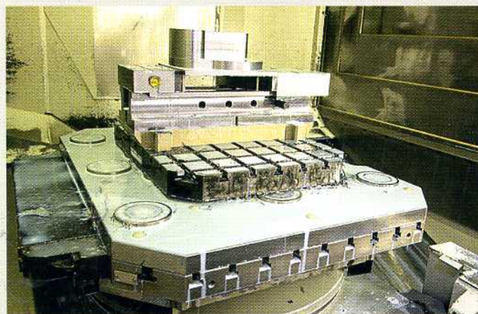
Die kraftvollen und kompakten Einbau-Spannmodule entwickeln Haltekräfte bis 55 kN.
