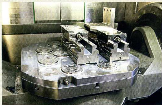
Mit AMF Nullpunktspannsystemen hat kocher-plastik drei Ziele erreicht: Rüstzeiten senken, Rüstvorgänge vereinfachen, Rüstvorgang außerhalb der Maschine.
