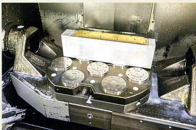
AMF Nullpunkt-Spannmodule K20 sorgen bei kocher-plastik für höhere Maschinenlaufzeiten.
