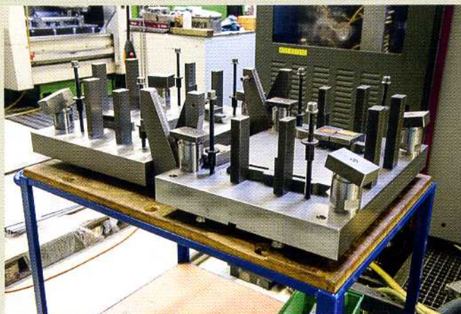
Die Grundplatte hat Spannrippel an der Unterseite für schnelles Rüsten mit dem AMF-Nullpunktspannsystem. Neben den messbaren Verbesserungen haben die Mitarbeiter mit ihrer Kreativität und mit Ideen für weitere Verbesserungen gesorgt.
