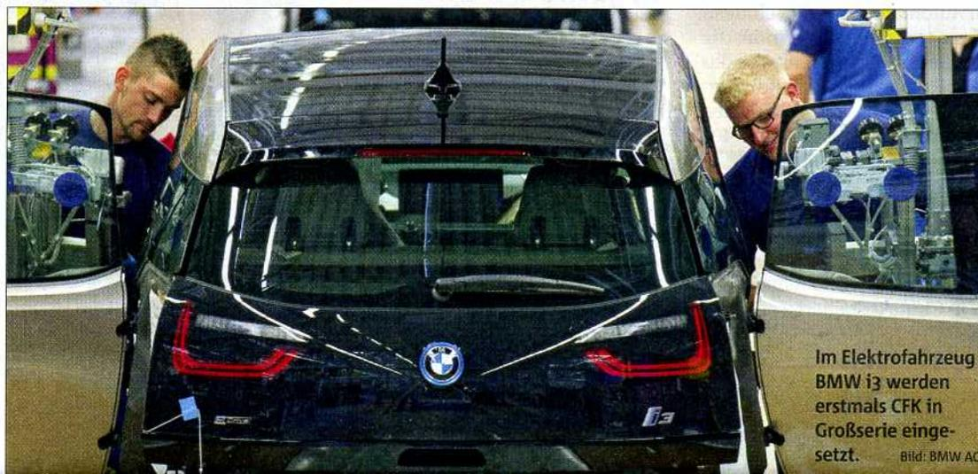
Im Elektrofahrzeug BMW i3 werden erstmals CFK in Großserie eingesetzt. Bild: BMW AG
