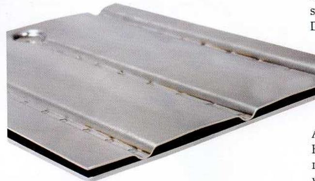
Maßhaltigkeit bei besserer Reproduzierbarkeit.“ Toleranzen von 1,5 % gegenüber den früheren 8 % belegen die gestiegene Fertigungspräzision. So können dünnere Bleche verwendet werden, was den Wärmeübergang verbessert und zudem die Materialkosten senkt.
