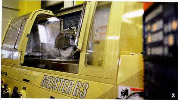
1 Die Schleiferei gehört im Betriebsmittelbau bei Blum traditionell zu den Kernbereichen. 2 Die Amada Meister G3 ermöglicht die Komplettbearbeitung auf einer Maschine und ersetzt mit ihrer Universalität zwei herkömmliche Schleifmaschinen. 3 Blum fertigt heute auf der Amada Teile, die früher nicht durch Schleifen herzustellen waren.
