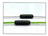
ten Festverdrahtungen für Kabeltypen AWG 22-27 herstellen. Die robuste Bauform des Verbindungsmoduls mit einem Zink-Druckguss-Gehäuse ist 360°-geschirmt und isoliert aufgebaut. Anwender können damit Leitungen verlängern, reparieren oder umverlegen, ohne dass die komplette Leitungsstrecke neu verlegt werden muss. (mz)
