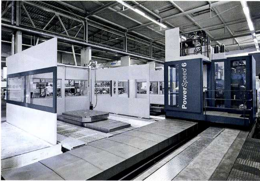
4 Das Maschinenbett auf der PowerSpeed 6 wurde auf 1220 mm verbreitert. Dadurch lässt sich die Quattro-Energiekette der X-Achse in das Maschinenbett integrieren
