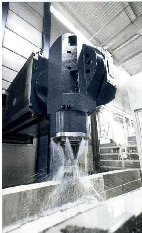
2 SHW Bearbeitungstechnik setzt die neue PowerSpeed 6 von SHW Werkzeugmaschinen immer öfter zum Schlichten auf langen Bahnen ein
