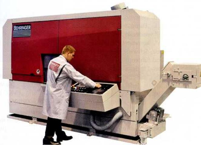
Der „SC-Kit“ sorgt bei der „HBM540A“ für höhere Schnittleistungen und eine längere Standzeit des Werkzeugs. *Bild: Behringer*
