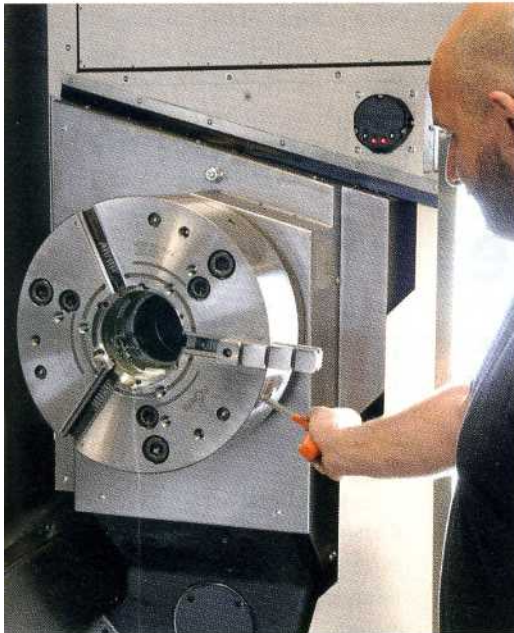
Bild 2: Das Kraftspannfutter Duro-NCSE Flex eignet sich besonders für Bearbeitungen mit häufigem Wechsel des Spannzeuges, da nur die Spanneinsätze mit einem Schnellwechselsystem getauscht werden.
