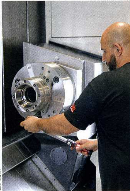
Bild 3: Eingerastet mit dem Bajonettverschluss und mit drei Schrauben verschraubt, ist das Futter sehr schnell einsatzbereit.
