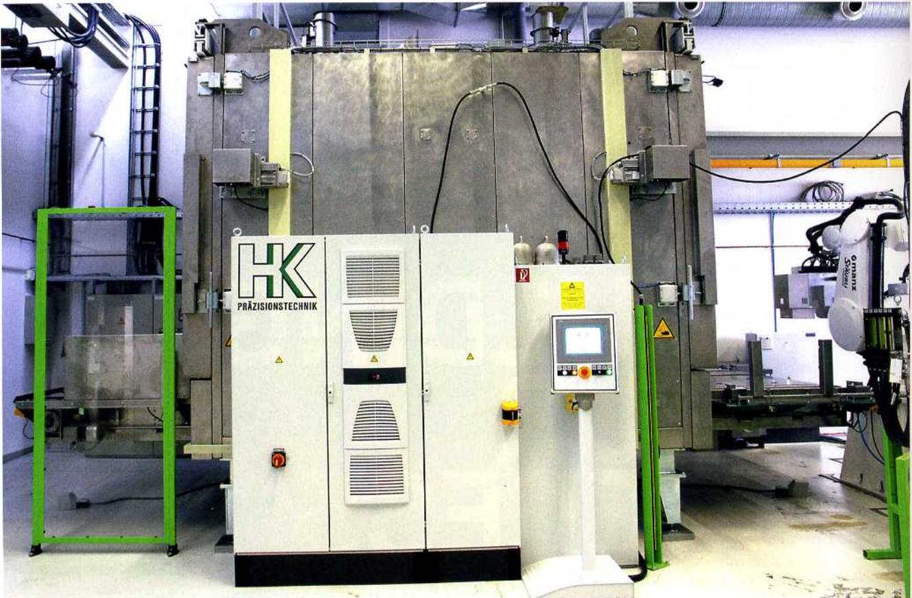
▲ Im Umluftofen werden erstmals 3D-Teile durch die zwei Kammern befördert und dabei schonend und gleichmäßig auf Prozesstemperatur erhitzt und durchwärmt.
