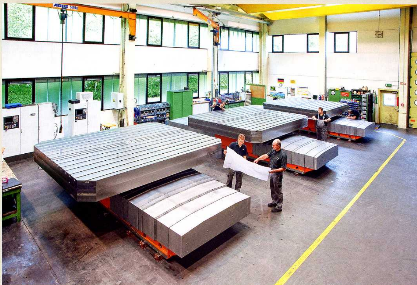
Der hocheffiziente FIBROMAX 2.0 verfügt über einen großen Lagerdurchmesser und ermöglicht hohe Transportlasten.
