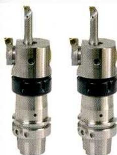
spindelwerkzeug Vario-Head einsetzbar, mit dem sich Bohrungen von 3 bis 152 mm Durchmesser bearbeiten lassen. Neben der höheren Genauigkeit profitieren Anwender von einem deutlichen Kostenvorteil, weil sie sich die Grundaufnahme ebenso einsparen können wie Verlängerungen und Reduzierungen.
