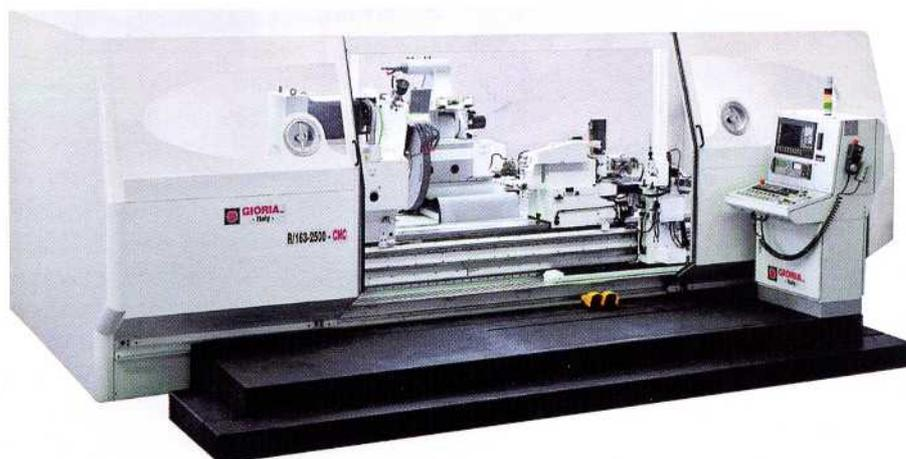
Platz und Bearbeitungszeit spart die neue Walzenschleifmaschine Gioria R162 CNC. Mit einer Spitzenweite von zwei Metern ist sie für die Bearbeitung mittelgroßer Werkstücke geeignet
