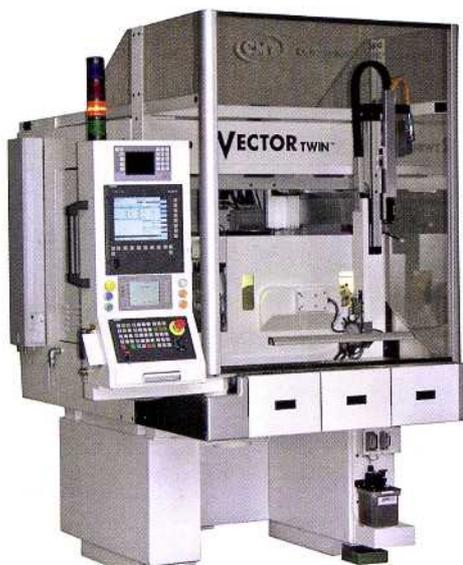
Mit der Doppelspindel-Rundschleifmaschine Vector Twin Mark IV von CMT präsentiert Tecnoteam Möglichkeiten zum vollautomatischen Schleifen von Einspritzdüsen
