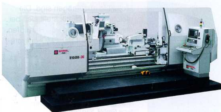
Bild 1: Platz und Bearbeitungszeit spart die neue Walzenschleifmaschine Gioria R162 CNC. Mit einer Spitzenweite von zwei Metern ist sie für die Bearbeitung mittelgroßer Werkstücke geeignet
