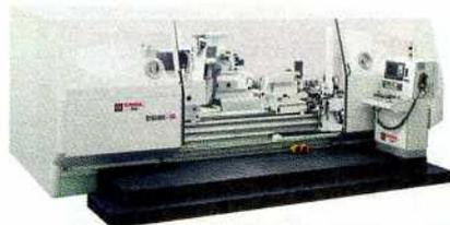
Die Walzenschleifmaschine Gloria R162 CNC von Tecno-Team eignet sich mit einer Spitzenweite von 2 m für die Bearbeitung mittelgroßer Werkstücke.
