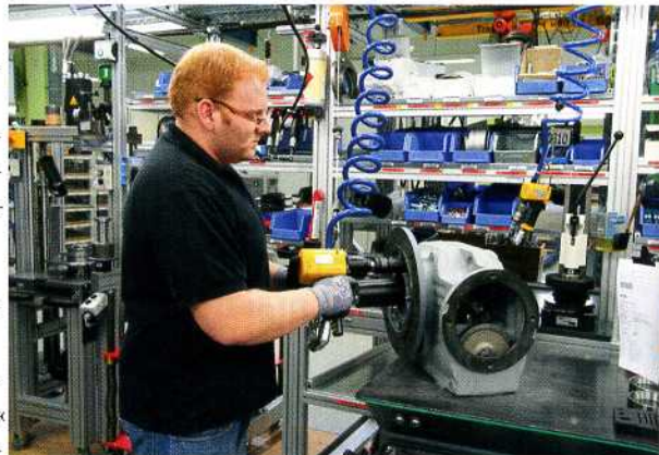
Der Einsatz der »QS-Loop«-Software ist hinsichtlich der verwendeten Werkzeuge frei; auch Druckluftwerkzeuge – hier ein Impulsschrauber von Atlas Copco – sowie Schrauber von Fremdanbietern lassen sich einbinden
