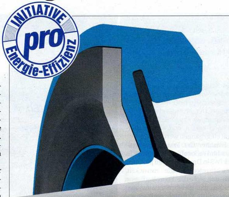
Das patentierte Dichtkonzept Turcon Roto L ermöglicht den optimalen Betrieb bei wechselnden Druckbelastungen. Im drucklosen Zustand kann sich die Reibung auf Null verringern.
