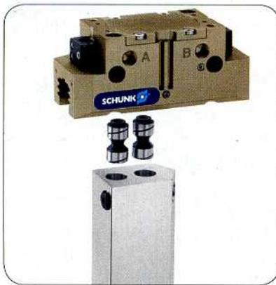
dass der Fingerwechsel in Sekundenschnelle per 90°-Drehung eines Innensechskantschlüssels wiederholgenau erledigt ist. Weil im Gegensatz zu den am Markt gängigen Lösungen keine Durchgangsbohrungen mehr durch den kompletten Finger nötig sind, profitieren Anwender zusätzlich von einem Höchstmaß an Gestaltungsfreiheit bei der Fingerkontur: Die Finger können über ihre komplette Länge
