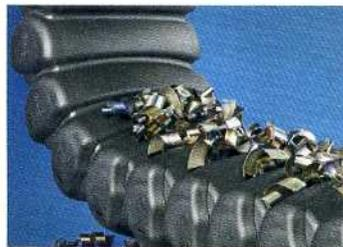
Das Kunststoff-Energierohr RX von Iigus bietet umfassenden Schutz gegenüber Spänen jeder Größe. Dies ergaben Tests über einen definierten Zeitraum von 100.000 Doppelhüben unter gleichmäßiger Zufuhr von Metallspänen unterschiedlichster
