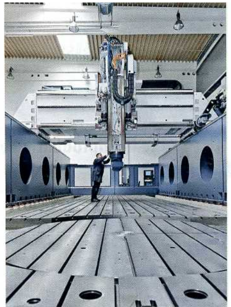
SHW hat den Maschinenständer einer Uni-Force-Maschine von der Vertikalen in die Horizontale gelegt und daraus eine Portalmaschine entwickelt
