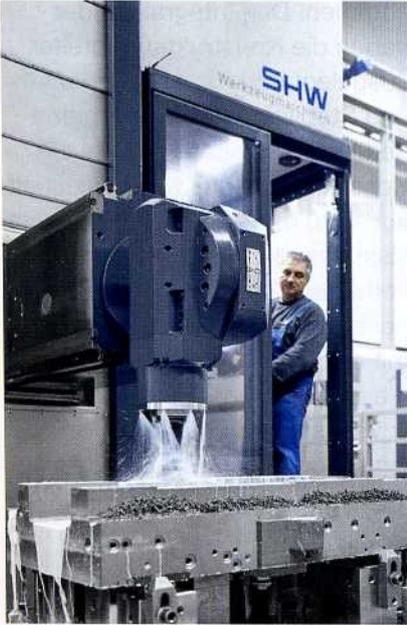
Bild 3: Bei kleinen Losgrößen, wie sie bei SHW Bearbeitungstechnik an der Tagesordnung sind, erhält der schnelle Eilgang der PowerSpeed 6 große Bedeutung
