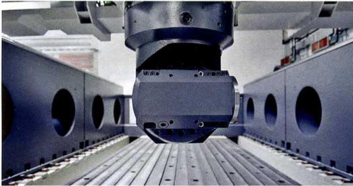
▲ SHW Werkzeugmaschinen hat den Maschinenständer einer hauseigenen „UniForce“-Maschine von der Vertikalen in die Horizontale gelegt und daraus eine Portalfräsmaschine entwickelt
