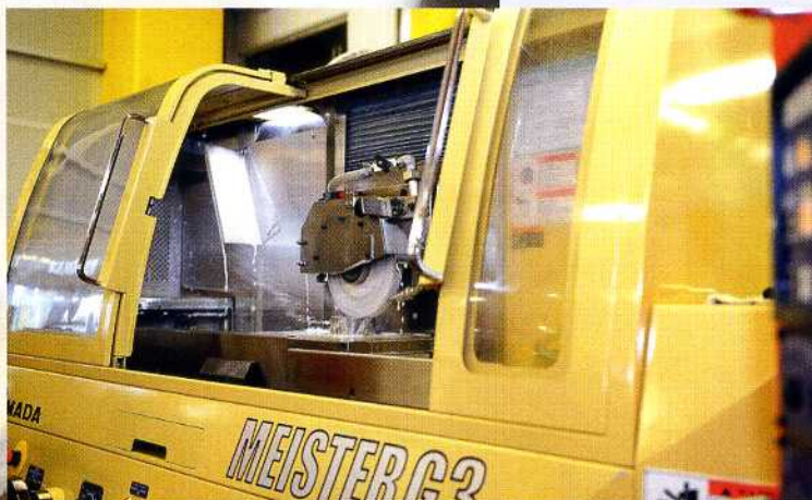
Die Amada Meister G3 ermöglicht die Komplettbearbeitung auf einer Maschine und ersetzt mit ihrer Universalität zwei herkömmliche Schleifmaschinen. Bilder: Blum
