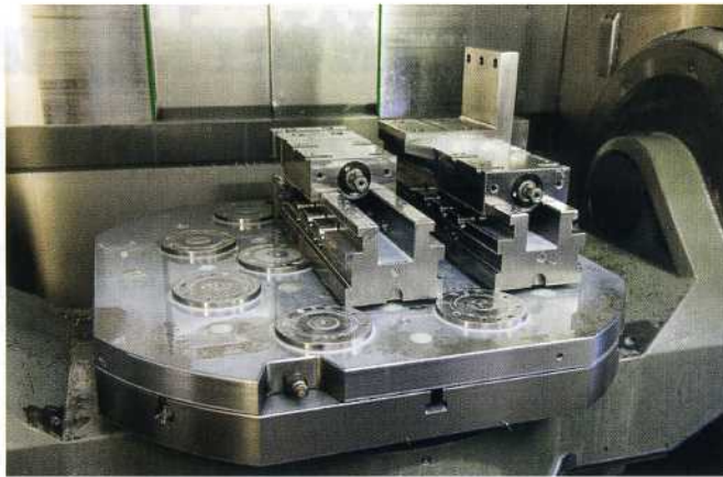
Mit Nullpunktspannsystemen lassen sich Rüstzeiten senken und Rüstvorgänge vereinfachen sowie aus der Maschine verlagern.
