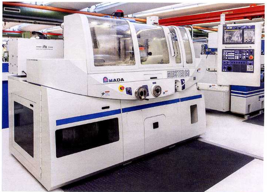
Bei Bihler sorgt die Amada Meister G3 für mehr Flexibilität. Die Schnellhub-, Flach- und Profilschleifmaschine übernimmt Arbeitsschritte, die früher auf drei Maschinen verteilt waren
