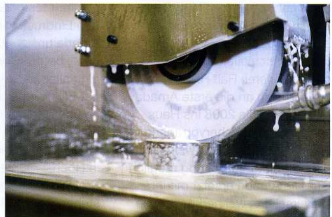
Bild 3: Bei Blum ist man beeindruckt von der sehr hohen Grundgenauigkeit der Amada Flach- und Profilschleifmaschinen. Die geforderte Präzision mit +/- 2,5 µm Toleranz ist machbar
