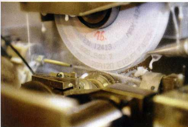
Bild 2: Zur hohen Genauigkeit kommt die durchdachte Abrichtfunktion der Amada Schleifmaschinen. Dafür sorgt die funktionelle CNC-Schleif- und Abrichttechnologie TPA/VPA zum Profilieren der Schleifscheibe
