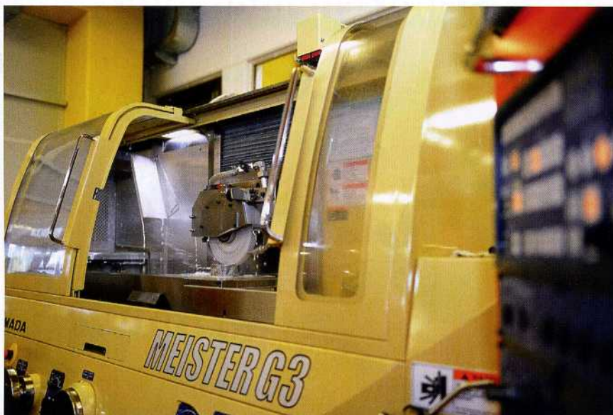
Bild 4: Die Amada Meister G3 ermöglicht die Komplettbearbeitung auf einer Maschine und ersetzt mit ihrer Universalität zwei herkömmliche Schleifmaschinen
