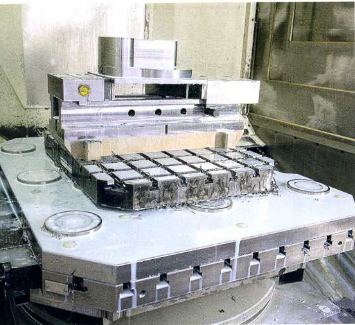
Die kraftvollen und kompakten Einbau-Spannmodule entwickeln Haltekräfte bis 55 kN.
