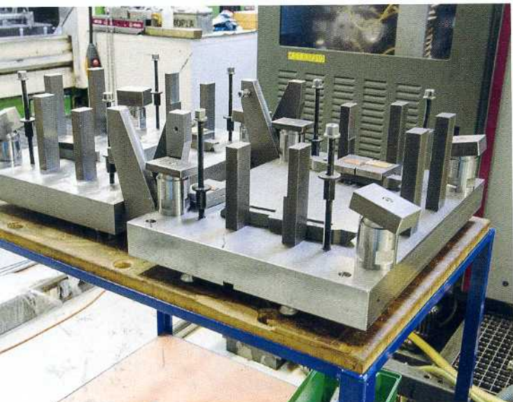
Die Grundplatte hat Spannippel an der Unterseite für schnelles Rüsten mit dem AMF-Nullpunktspannsystem. Neben den messbaren Verbesserungen haben die Mitarbeiter mit ihrer Kreativität und mit Ideen für weitere Verbesserungen gesorgt.
