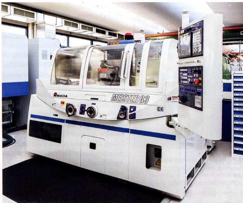
**1** Bei Bihler sorgt die Amada Meister G3 für mehr Flexibilität. Die Schnellhub-, Flach- und Profilschleifmaschine übernimmt Arbeitsschritte, die früher auf drei Maschinen verteilt waren
