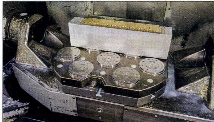
AMF Nullpunkt-Spannmodule K20 sorgen bei Kocher Plastik für höhere Maschinenlaufzeiten.
